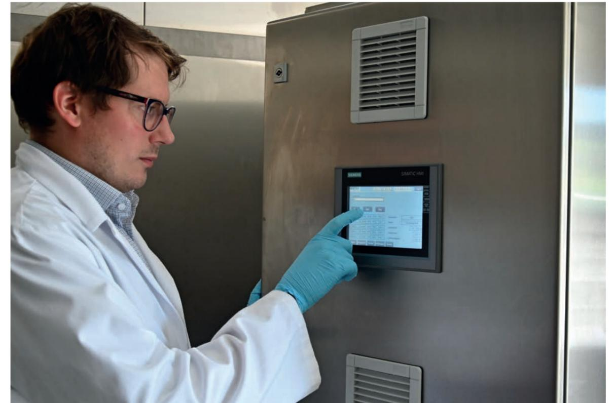
Bei anspruchsvollen Produkten können in der Steuerung fünf Phasen mit unterschiedlichen Parametern im jeweiligen Trocknungsprofil hinterlegt werden. (Bilder: Harter)
