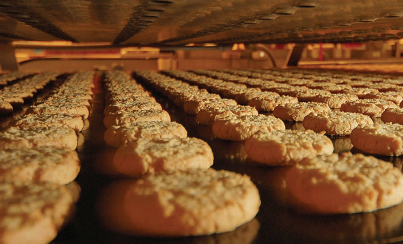
Stahlbänder der Berndorf Band Group mit hoher Temperaturleitfähigkeit tragen zu einer gleichmäßigen Produktqualität bei. Steel belts for the baking industry from Berndorf Band Group contribute to seamless processes and to a constant product quality.
