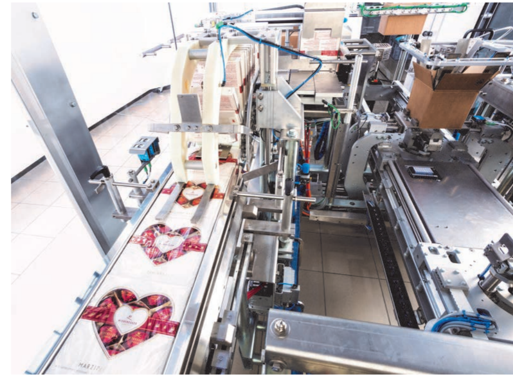
Die Schachteln mit den Marzipanpralinen laufen einbahnig direkt aus der Packstraße quer liegend in die TLM-Anlage ein. The boxes with marzipan pralines are fed into the TLM system from the packing line in a single lane, lying crosswise.
