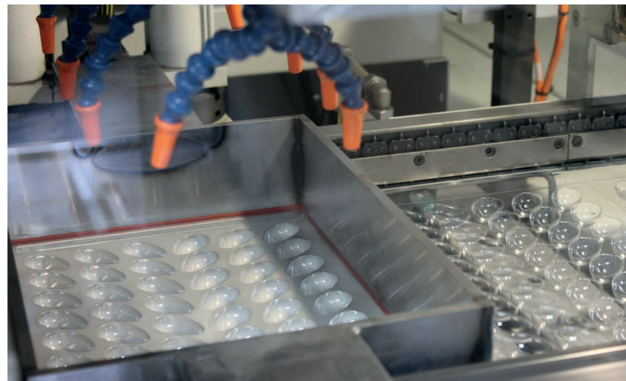
Herstellung von One-Shot-Formen für Schokoladeneier im Thermoformprozess. Manufacture of one-shot moulds for chocolate eggs in the thermo-mould process.
