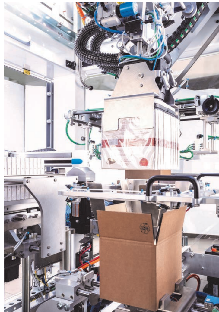
Ein F2-Roboter setzt die Pralineschachteln in den Versandkarton. (Bilder: Schubert) An F2 robot places the boxes of pralines into the shipping carton. (Images: Schubert)
