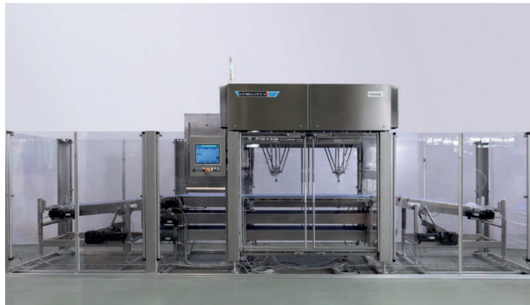
Der fortschrittliche Hygienic Conveyor für die chemische Reinigung und der Roboter mit integriertem Puffer. (Bild: Rotzinger Group)
