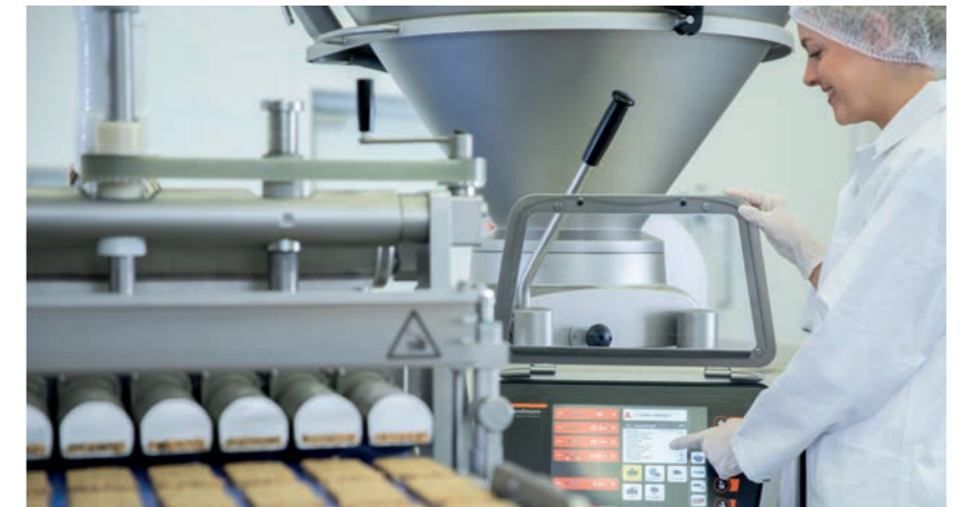
Digitale Lösung Handtmann Monitoring Function (HMF) mit Signalleuchte am Vakuumfüller VF 800. (Bild: Handtmann) Handtmann Monitoring Function (HMF) digital solution with signal lamp on the VF 800 vacuum filler. (Image: Handtmann)
