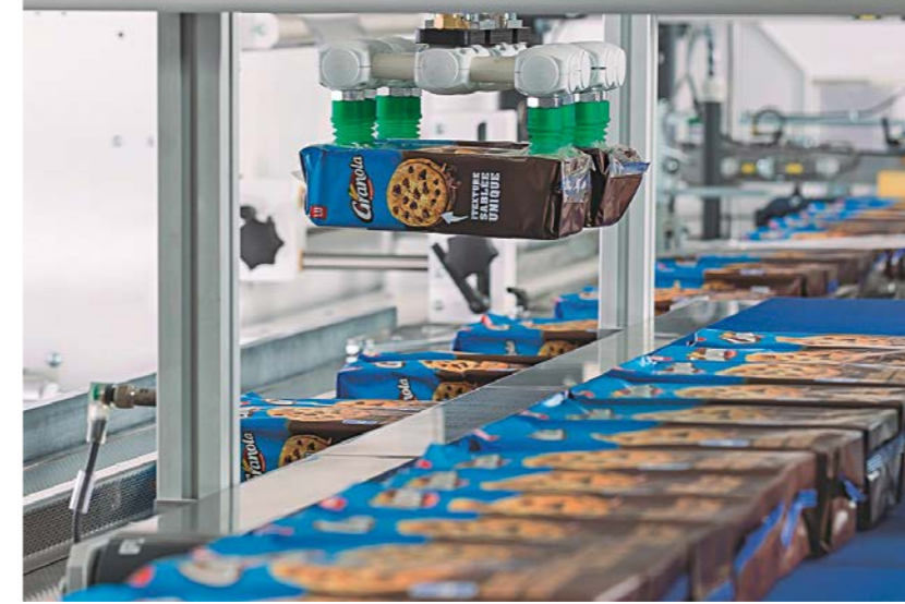
Der Parallelroboter nimmt Keksschachteln auf und gruppiert sie in der Zuführkette der Folienverpackungsmaschine. The parallel robot picks up biscuit boxes and groups them in the feed chain of the film packaging machine.
