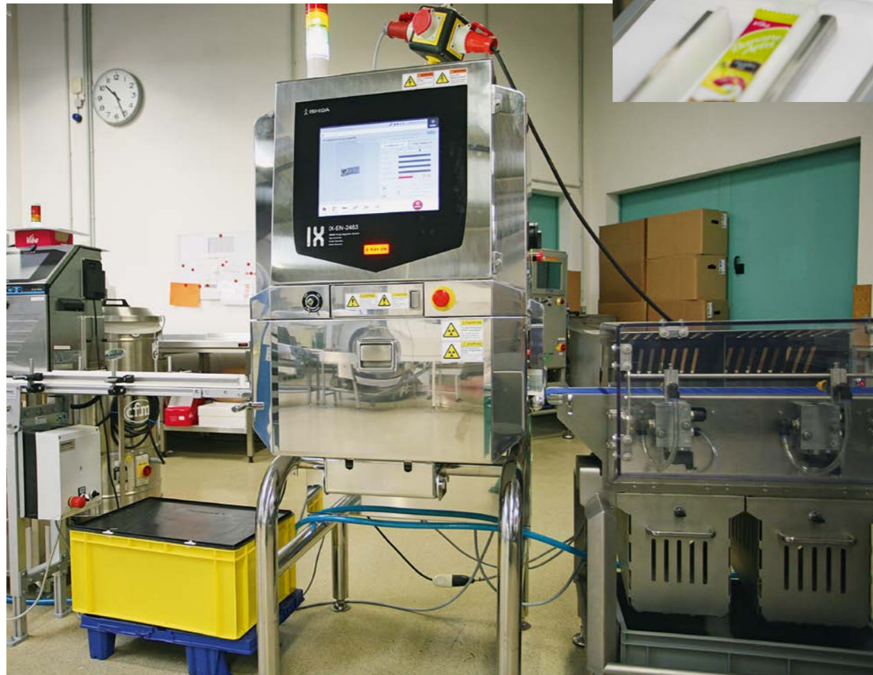
Das Röntgenprüfsystem IX-EN wurde vor der Endverpackung in die Produktionslinie integriert. (Bilder: Ishida) The X-ray inspection system IX-EN was integrated into the production line before final packaging. (Images: Ishida)
