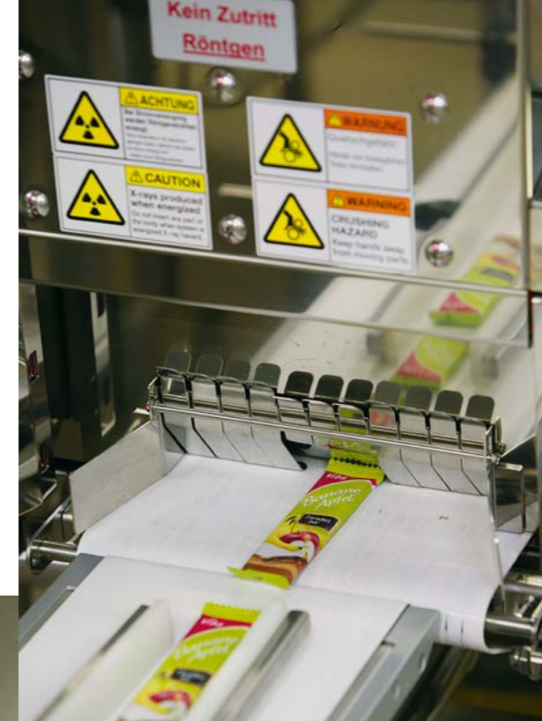
Die relativ leichten Produkte passieren die Edelstahlvorhänge ohne Beeinträchtigung. The relatively light-weight products pass through the stainless-steel curtains without negative impact.
