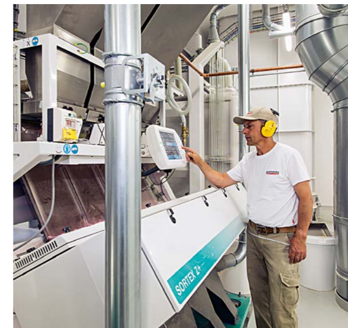
Ein Müllermeister beim Bedienen eines optoelektronischen Farbauslesers. Hier werden dunkle Haferkörner und ungeschälte Kerne aussortiert. A master miller operating an optoelectronic colour reader. Here, dark oat grains and unpeeled kernels are sorted out.
