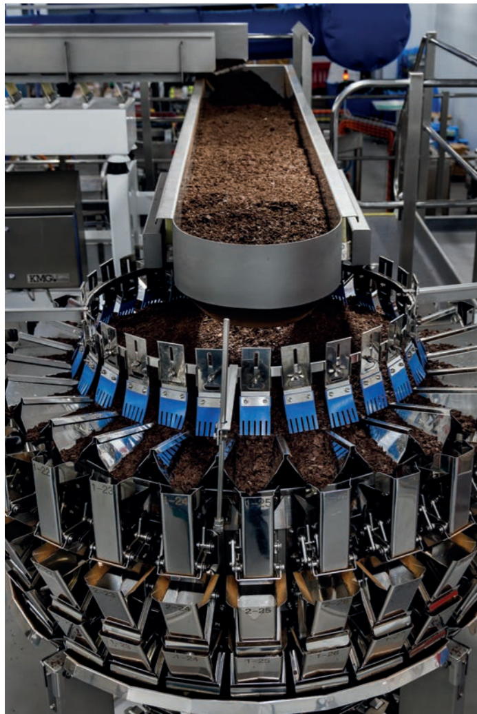
Die Mehrkopfwaagen erreichen bei hoher Genauigkeit eine Geschwindigkeit von 210 Wiegungen pro Minute. The multihead weighers achieve a speed of 210 weighments per minute with high accuracy.
