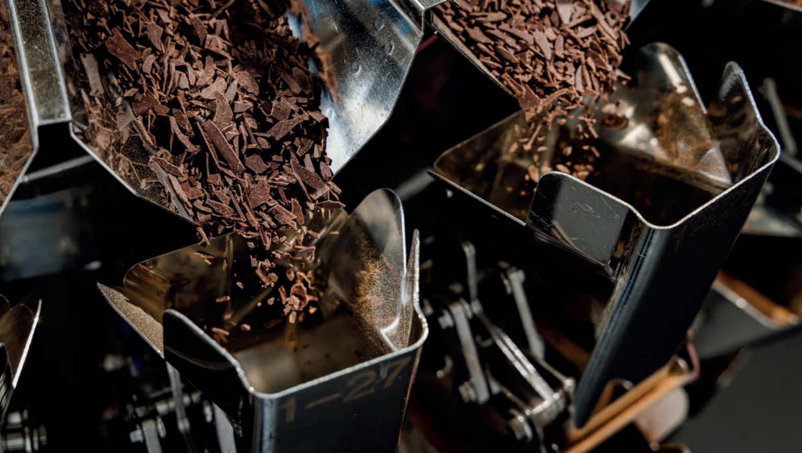
Die Schokoflocken werden kontrolliert in die Schalen befördert. (Bilder: Ishida) The chocolate flakes are conveyed into the trays in a controlled manner. (Images: Ishida)
