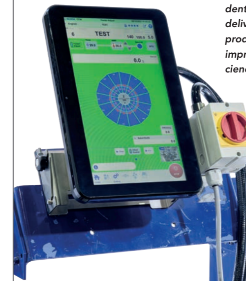
Der Touchscreen der Mehrkopfwaage CCW-AS erlaubt eine komfortable Bedienung. The touch screen of the CCW-AS multihead weigher allows for convenient operation.
