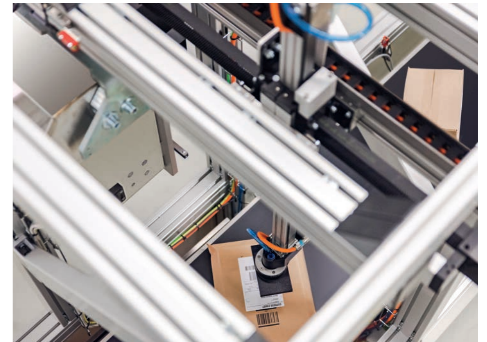
Mit dem 3D-Etikettierportal Legi-Flex 6100 erübrigt sich das aufwendige Ausrichten von Produkten entlang einer Referenzkante. The Legi-Flex 6100 3D labelling portal eliminates the need for time-consuming alignment of products along a reference edge.
