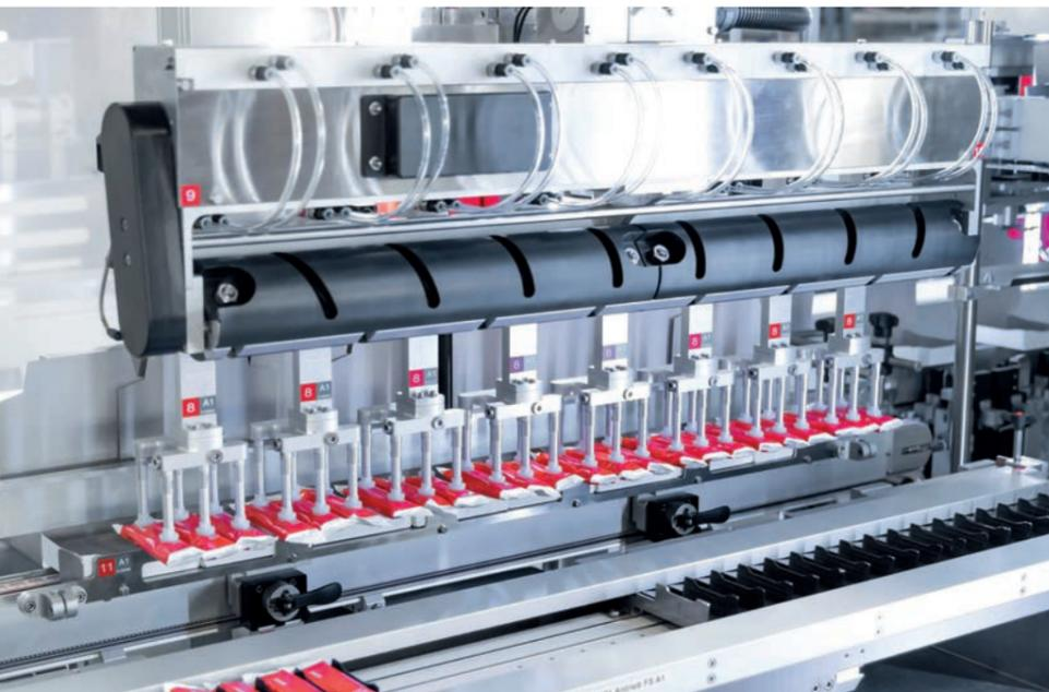
Ein Greiferkopf mit Vakuumsaugtechnik sorgt für die schonende Handhabung der Riegel.
