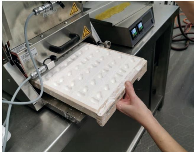
Die Universal-Gießmaschine von Truffly Made kann jede gießfähige Masse verarbeiten. (Bild: DataSweet/Truffly Made)
