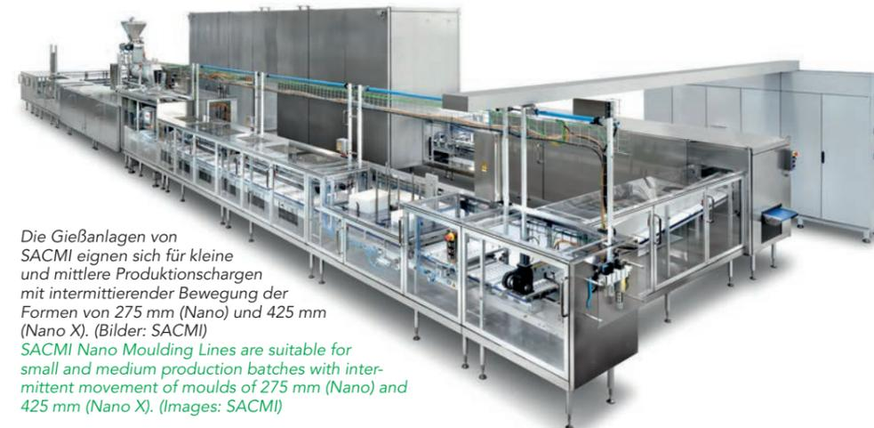
Die Gießanlagen von SACMI eignen sich für kleine und mittlere Produktionschargen mit intermittierender Bewegung der Formen von 275 mm (Nano) und 425 mm (Nano X). (Bilder: SACMI) SACMI Nano Moulding Lines are suitable for small and medium production batches with intermittent movement of moulds of 275 mm (Nano) and 425 mm (Nano X). (Images: SACMI)
