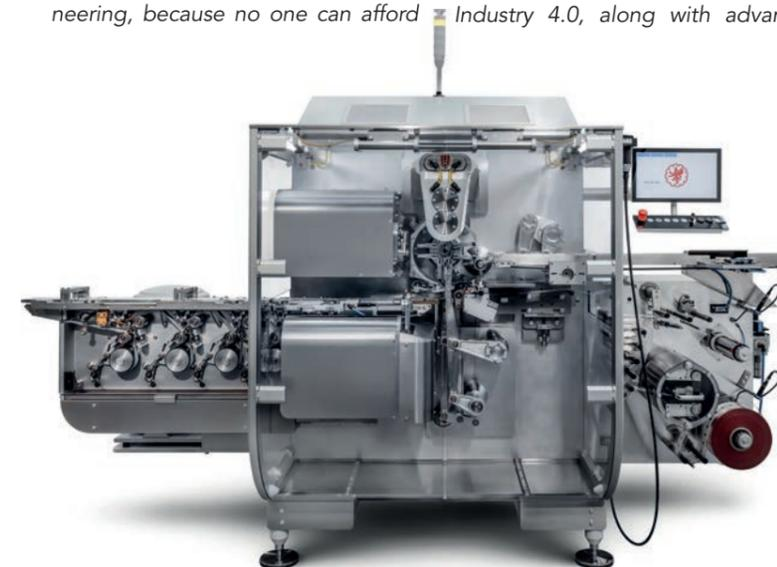
Die jüngste Generation von Hochgeschwindigkeits-Verpackungssystemen wurde so konzipiert, dass Elektronik und Mechanik im Inneren der Maschinen in Kombination eingesetzt werden, um deren Vorteile zu maximieren. The new generation of high speed wrapping systems with its Hybrid Drive concept has been created with electronics and mechanics inside the machines. The components are used in combination in order to maximize their benefits.
