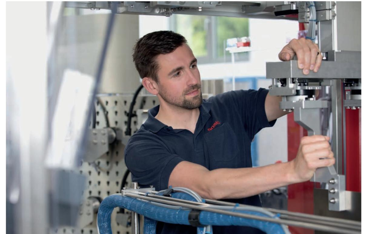
Schneller und sicherer Formatwechsel mit dem Somic-Quick-Change-System. (Bilder: Somic) Quick and safe format change with the Somic Quick Change system. (Images: Somic)
