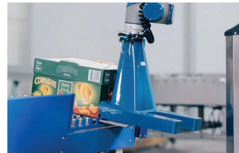
Die maßgeschneiderten kollaborierenden Roboterarme mit verschiedenen Größen und Greifern lassen sich leicht in ein bestehendes Produktionsumfeld integrieren. The tailor-made collaborative robot arms with different sizes and grippers can be integrated easily into an existing production environment.
