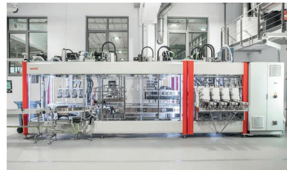
Auf lediglich 14 m<sup>2</sup> werden pro Minute 800 Riegel in 120 Kartons verpackt.
