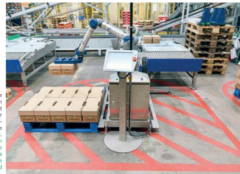
Der maximale Arbeitsbereich des Cobots ist hier mit der roten schraffierten Fläche markiert. The maximum working range of the robot is marked here by the red created area.
