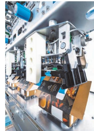
Das kostengünstige, leicht zu verarbeitende Design der Schachteln für das Bag-in-Box-Konzept wurde von Schubert neu entwickelt. The cost-effective, easy-to-process design of the cartons for the bag-in-box concept was newly developed by Schubert.
