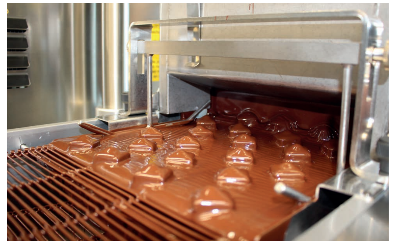
Produkte des Kunden im Überzug auf einer LCM-Maschine. Customer's products coated on an LCM machine.
