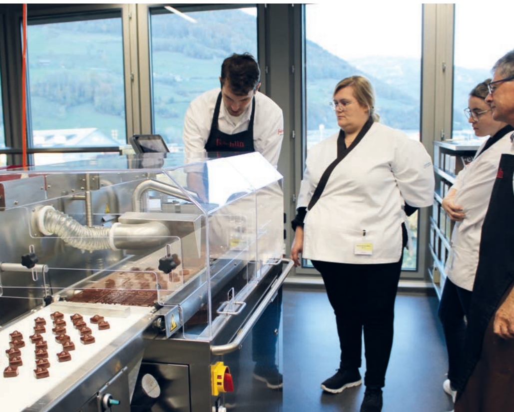
Produkte des Kunden werden auf einer LCM-Maschine im Condorama überzogen. The customer's products are coated on an LCM machine in Condorama.
