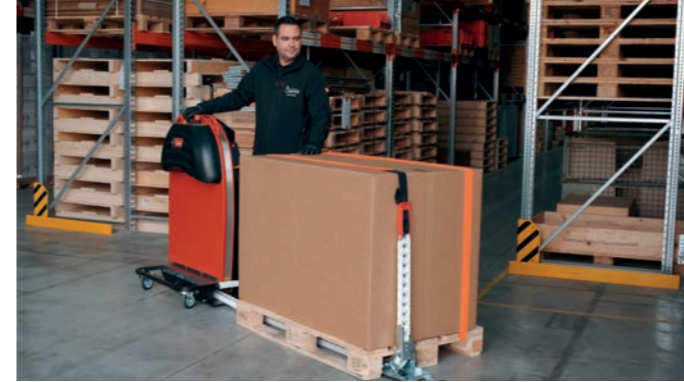
Die ErgoPack RE im Einsatz – die Kettenlanze bringt das Band automatisch um das Packgut. The ErgoPack RE in action – the Chain Lance automatically wraps the strap around the packaged goods.
