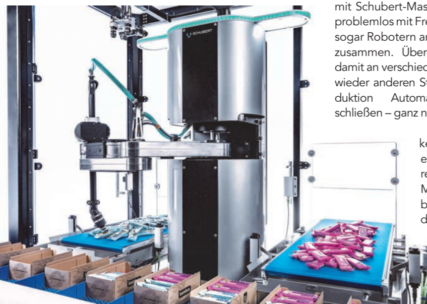
Mit bis zu 90 Takten pro Minute greift der Tog.519 Süßwarenprodukte aus der Kiste oder vom Band und platziert sie in jedes denkbare Ziel – ohne aufwendige Programmierung.
