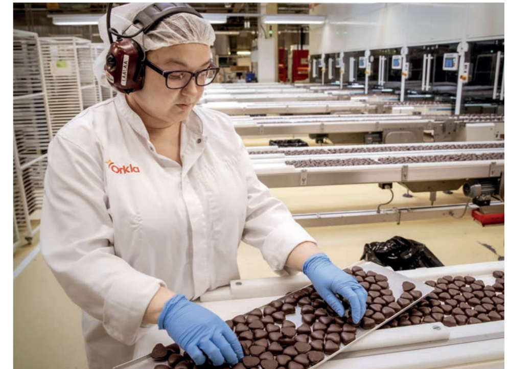
Neben den allgemeinen Funktionstests wurde vor allem die zweibahnige Zuführung der Maschine – eine Besonderheit – genau getestet. In addition to the general functional tests, the machine's two-lane infeed – a unique feature – was tested in detail.
