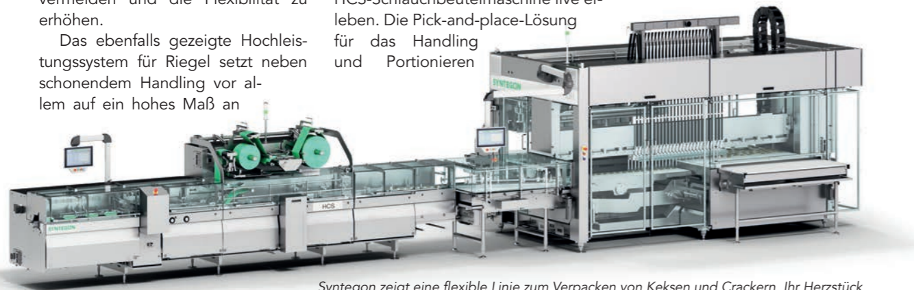
Syntegon zeigt eine flexible Linie zum Verpacken von Keksen und Crackern. Ihr Herzstück, die Syntegon IDH, arbeitet besonders schonend. (Bild: Syntegon) Syntegon will show a flexible line that packages cookies and crackers. At the heart of the line is the Syntegon IDH which operates particularly gently. (Image: Syntegon)
