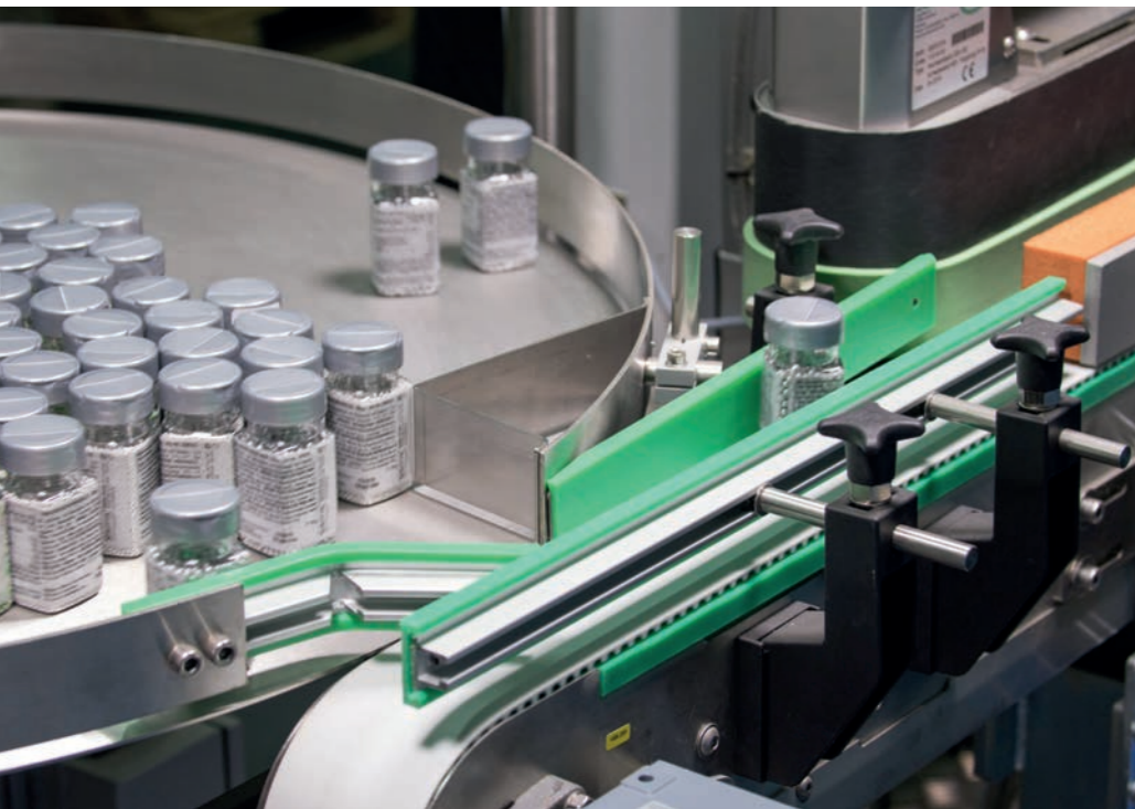
Die Etikettieranlage kennzeichnet runde und eckige Kunststofffläschchen gleichermaßen zuverlässig. The labelling system reliably labels round and square plastic bottles.
