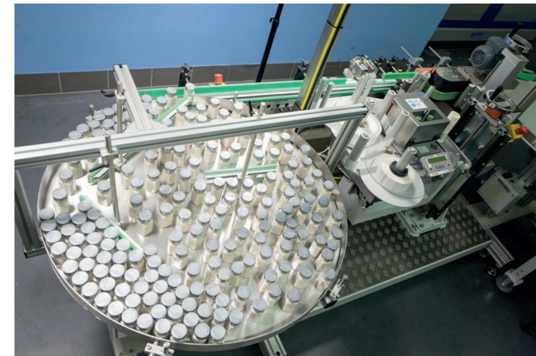
Die Produkte gelangen auf einen Auslaufdrehteller, von wo aus sie manuell verpackt werden. The products proceed to a rotating tray where they are manually packaged.
