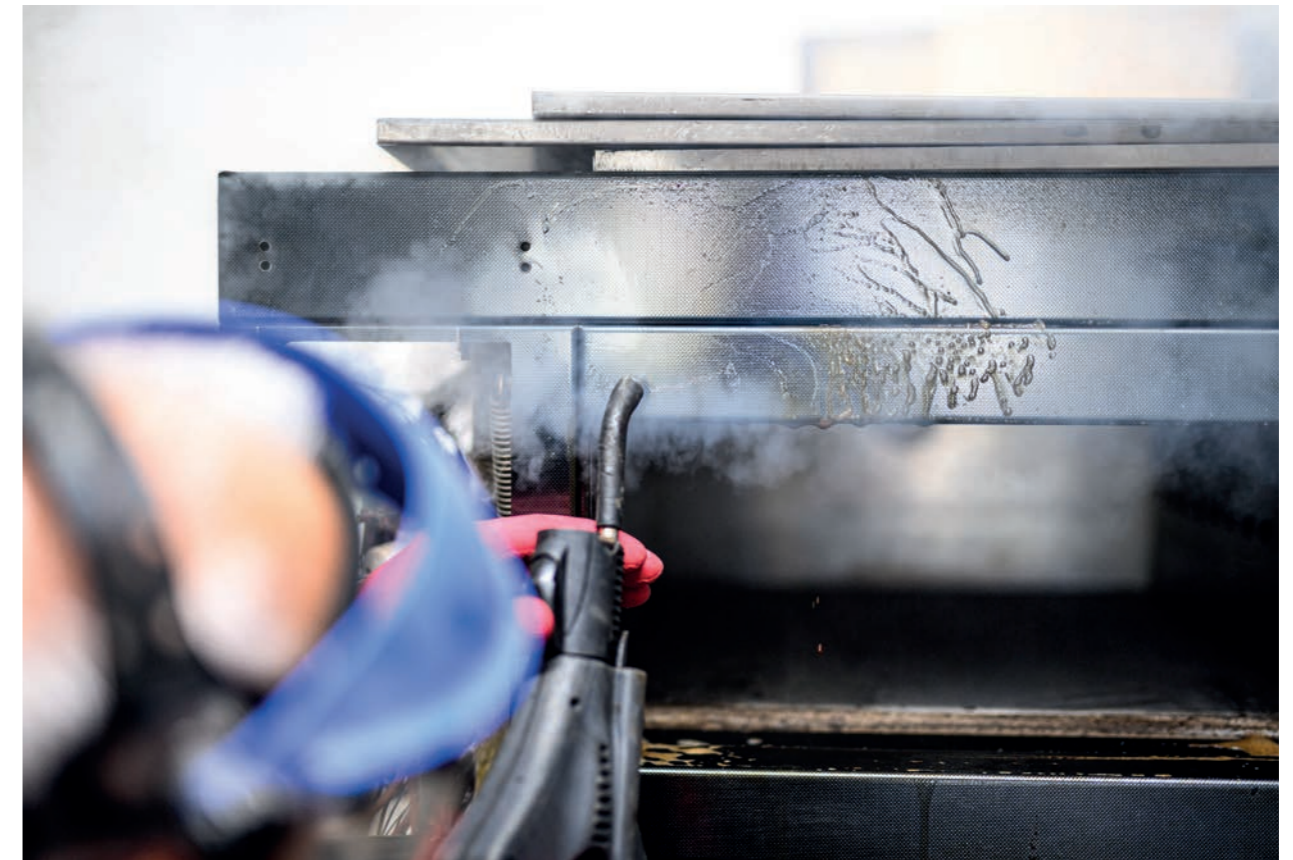
Das Dampfsaugsystem löst selbst sehr harte Verschmutzungen wie eingebrannte Teig- und Fettreste rückstandslos. The steam vacuum cleaner removes even very stubborn soiling such as baked-on dough and fat remnants without leaving any residue.
