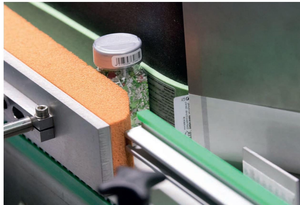
Das Etikett bleibt am Fläschchen haften und wird in der weiteren Bewegung „mitgenommen“. The label sticks to the little bottle and is fully attached as the bottle travels by.
