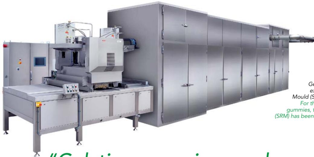
Für das puderlose Gießen von Gelatineprodukten wurde die bereits existierende Anlage Silicone Rubber Mould (SRM) weiterentwickelt. (Bild: Bosch)
