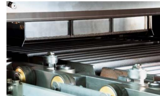
Das Funktionsprinzip basiert auf einem bewährten Konzept: Am Ofen-Vorkopf wird Waffelteig auf die unteren Platten der beheizten Backplattenpaare aufgegossen, die an einer Backzangenkette montiert sind. Die Platten schließen sich und durchlaufen den Ofen. Nach einer Runde durch den Ofen öffnen sich die Platten
