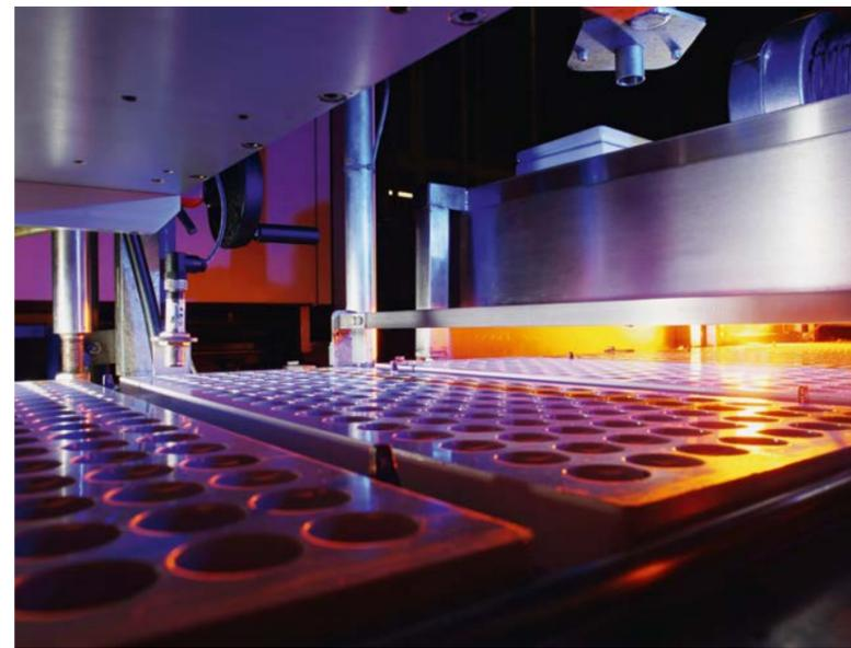
Da die Polycarbonat-Formen die Infrarot-Strahlung sehr gut absorbieren, ist die gesamte Form nahezu gleich temperiert. (Bild: Heraeus Noblelight).
