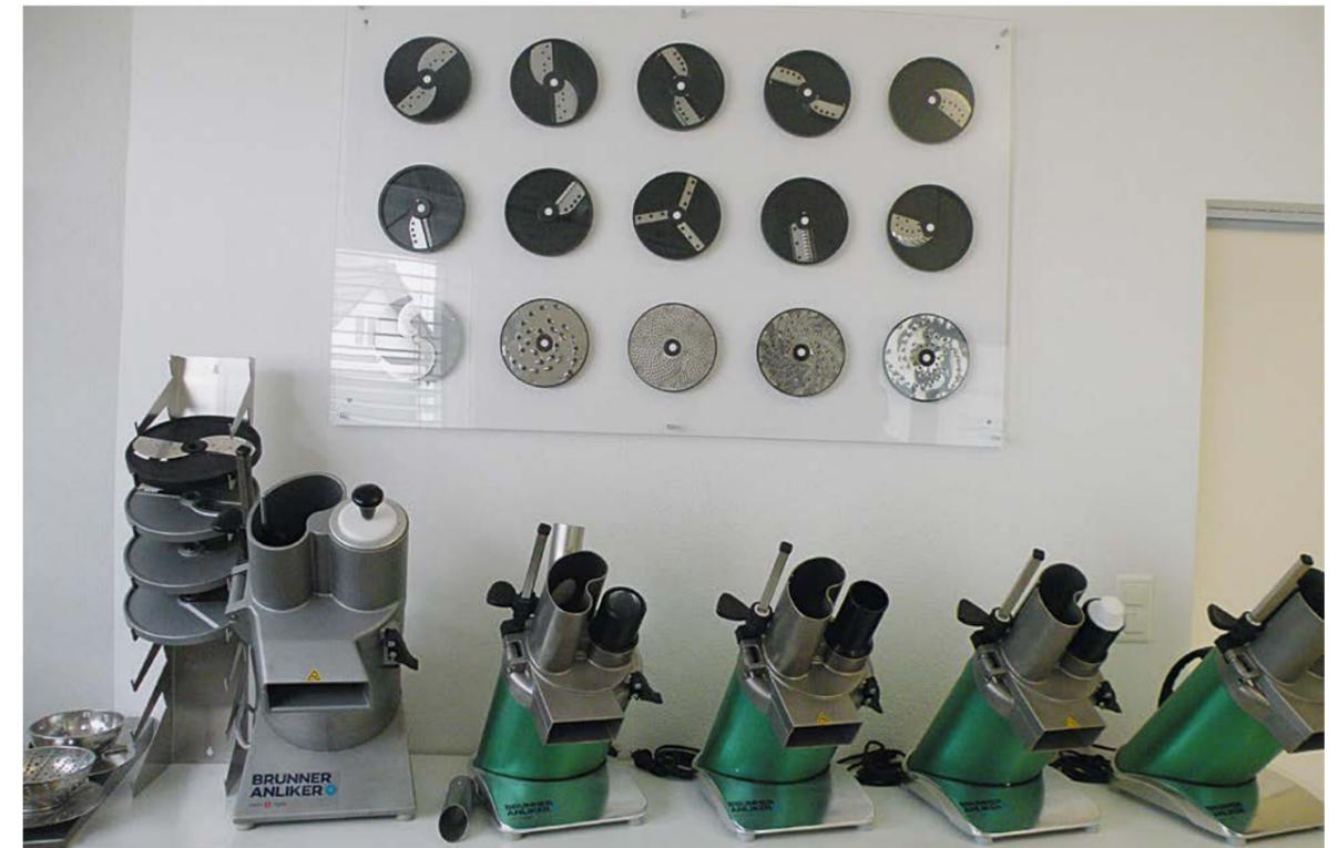
Gemüse- und Früchteschneidemaschinen der Serie GSM, die in der Süßwarenindustrie für Laboranwendungen eingesetzt werden.
