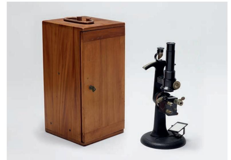
Refraktometer werden eingesetzt, um die Konzentration der in einer Flüssigkeit gelösten Stoffe zu messen. (Bild: Autor)
