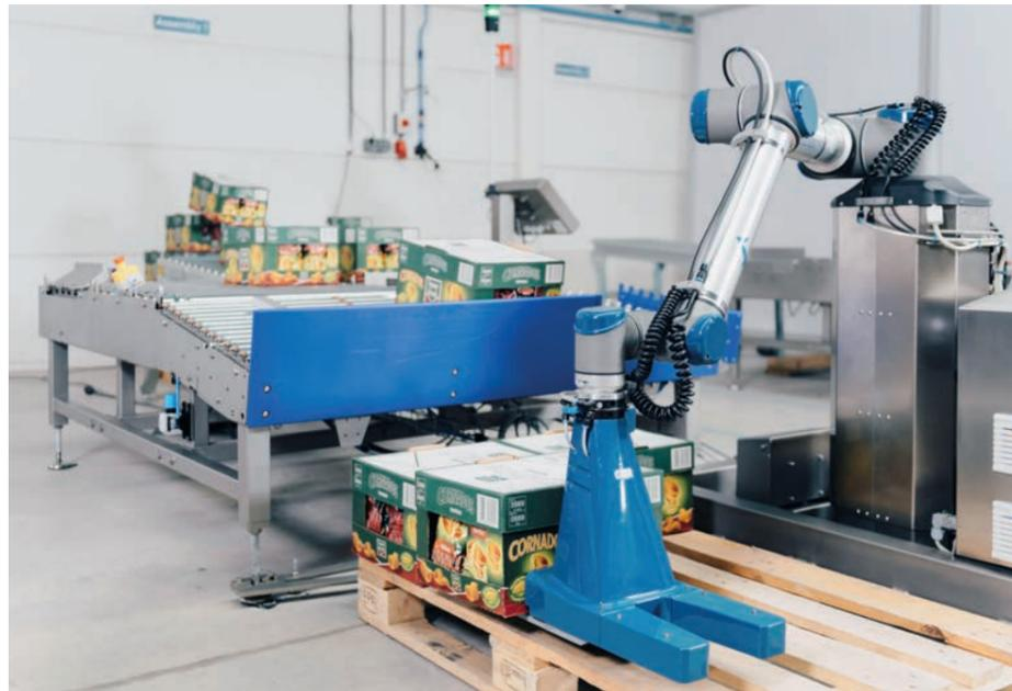
Durch den Einsatz eines Palettierers lässt sich Arbeitskräftemangel überwinden. Labor shortages can be overcome by implementing a palletizer.
