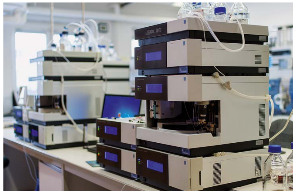
Hochleistungs-Flüssigchromatographie-Anlage (HPLC) zur Bestimmung mittel- bis schwerflüchtiger organischer Verbindungen mit optischen Detektoren. HPLC (high performance liquid chromatograph) for the identification of medium to semi-volatile organic compounds with optical detectors.
