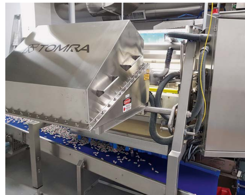
Die Kombination von Verfahren eignet sich sehr gut zur verlässlichen Detektion fehlerhafter Artikel. The combination of technologies perfectly addresses the challenge of reliably detecting imperfect products.
