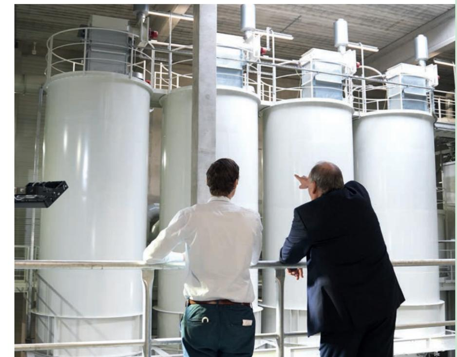
Mithilfe der neuen Windsichtungsanlage lassen sich funktionelle Mehle mit einem Eiweißgehalt von bis zu 65 % erzeugen. By means of the new air separation plant, functional flours with a protein content of up to 65 % can be produced.
