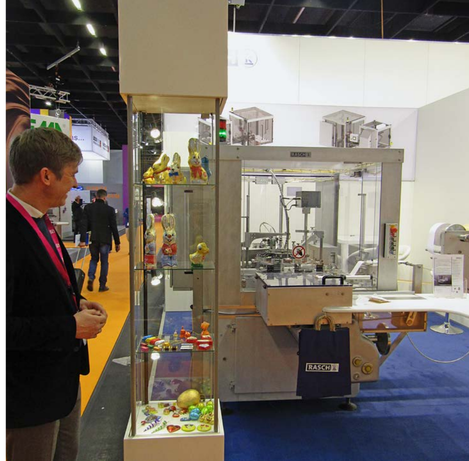
Auf der Messe ProSweets 2019 zeigte Rasch eine weiterentwickelte Universal-Verpackungsmaschine des Typs RU mit neuer Tafelwickleinheit. At ProSweets 2019 trade fair, Rasch exhibited the latest advanced version of its RU model universal packaging machine with a new bar wrapping unit.
