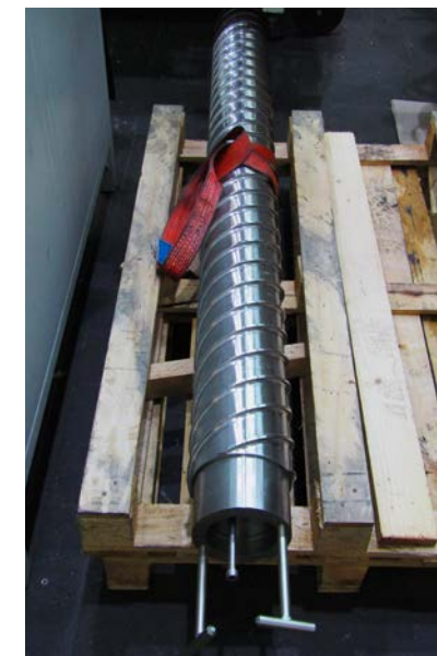
Bei Rasch gefertigte Temperierschnecke. Diese lässt sich bei Massewechslern oder zum Reinigen leicht aus der Maschine nehmen.
