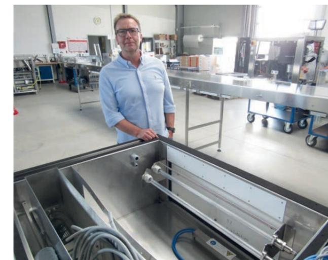
Markus Leute: „Für alle Kühltunnel von LCM sind ab sofort UV-Lampen zur sicheren Entkeimung im Produktionsprozess erhältlich.“
