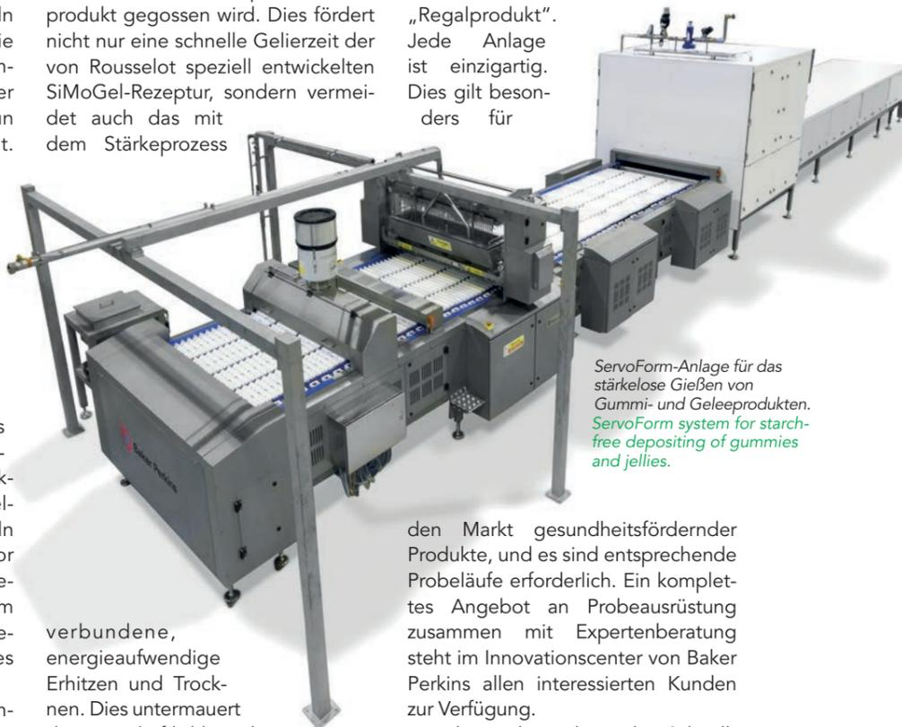
ServoForm-Anlage für das stärkefreie Gießen von Gummi- und Geleeprodukten. ServoForm system for starch-free depositing of gummies and jellies.
