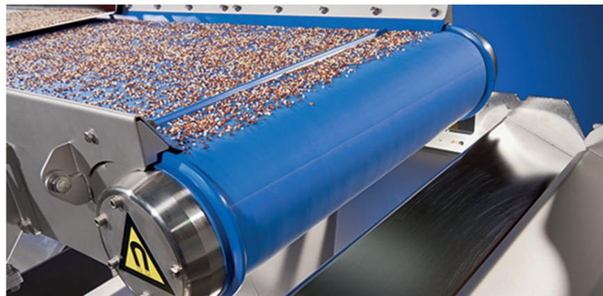
Der High-Gradient-Abscheider filtert Metallteilchen effizient und sicher aus dem Produktstrom. (Bild: Goudsmit)
