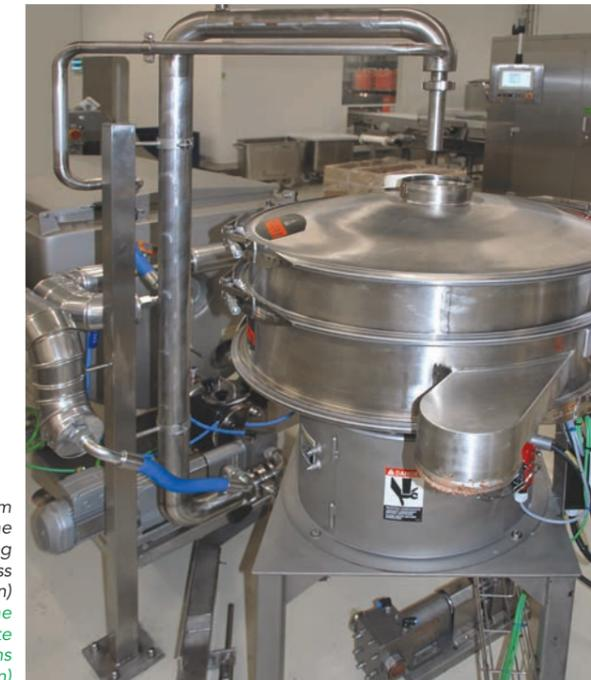
Feststoffe treten durch einen Auslass am Rand des Siebs aus, während geschmolzene Schokolade durch eine untere Öffnung austritt und zum Produktionsprozess zurückgeleitet wird. (Bild: Kason)
