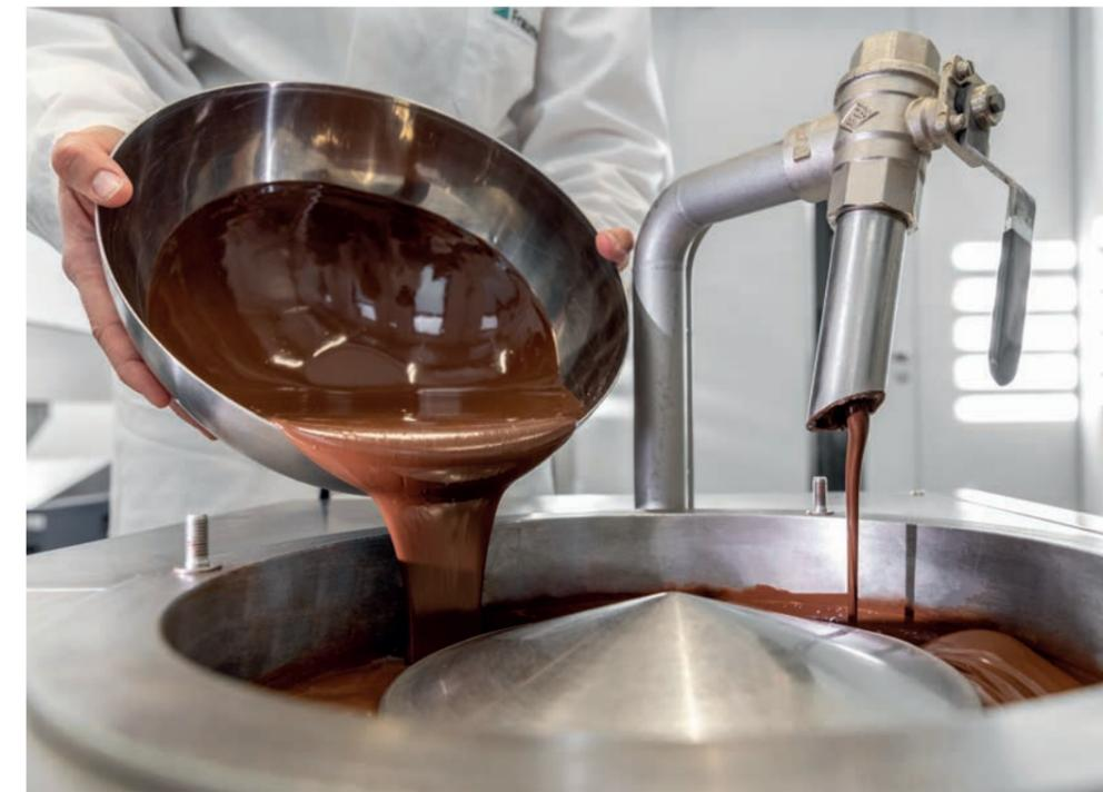
Mit Hilfe der Temperiermaschine im Schokoladentechnikum wird eine ausreichende Menge an stabilen  $\beta$ -V-Kristallen in der Kakaobutter generiert.
