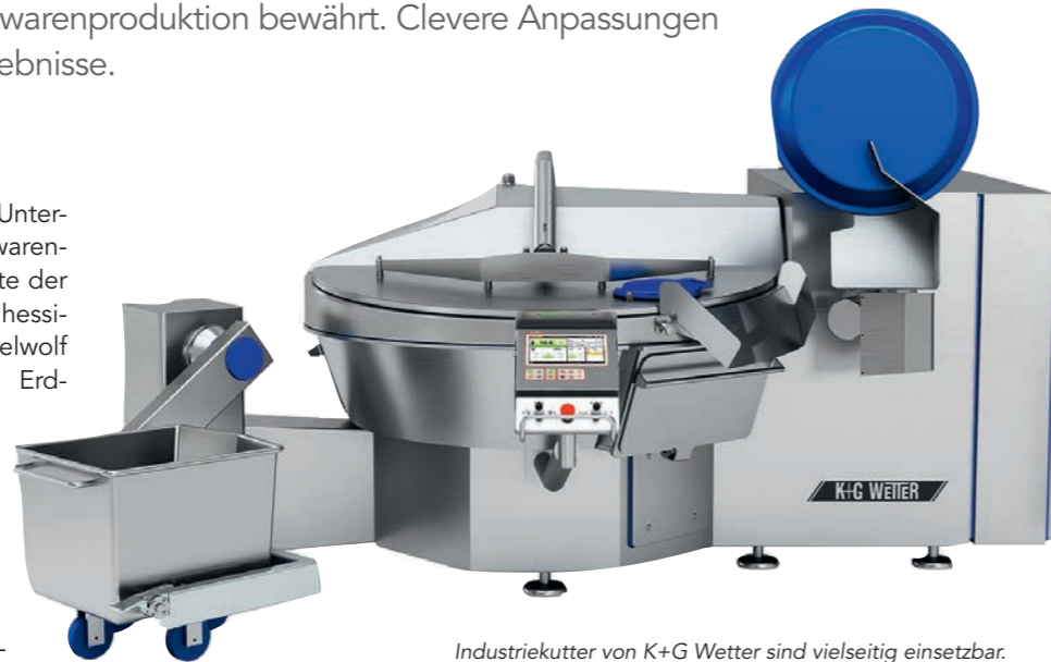
Industriekutter von K+G Wetter sind vielseitig einsetzbar. Im Bild der Vakuum Cutmix (VCM) aus der Serie Hygienic Secure. Industrial bowl cutters from K+G Wetter are versatile. The picture shows the Vacuum Cutmix (VCM) from the Hygienic Secure series.
