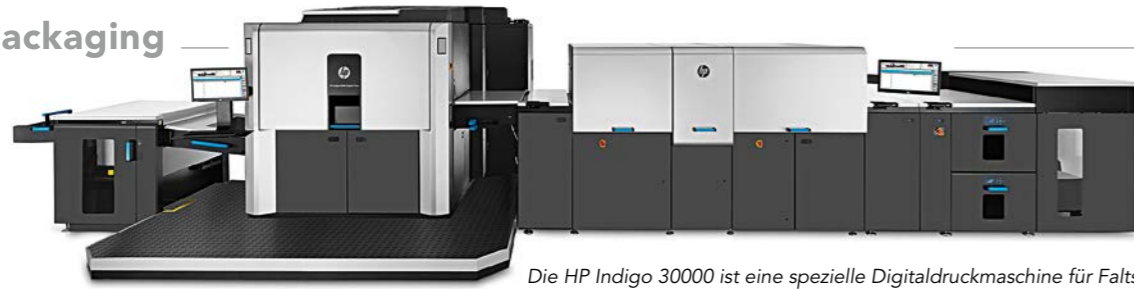
Die HP Indigo 30000 ist eine spezielle Digitaldruckmaschine für Faltschachteln und sorgt mit dem automatischen Colour Management für eine höhere Produktivität. The HP Indigo 30000 is a one-of-a-kind, field proven, digital folding carton press. It boosts productivity with automated colour management and converting solutions.
