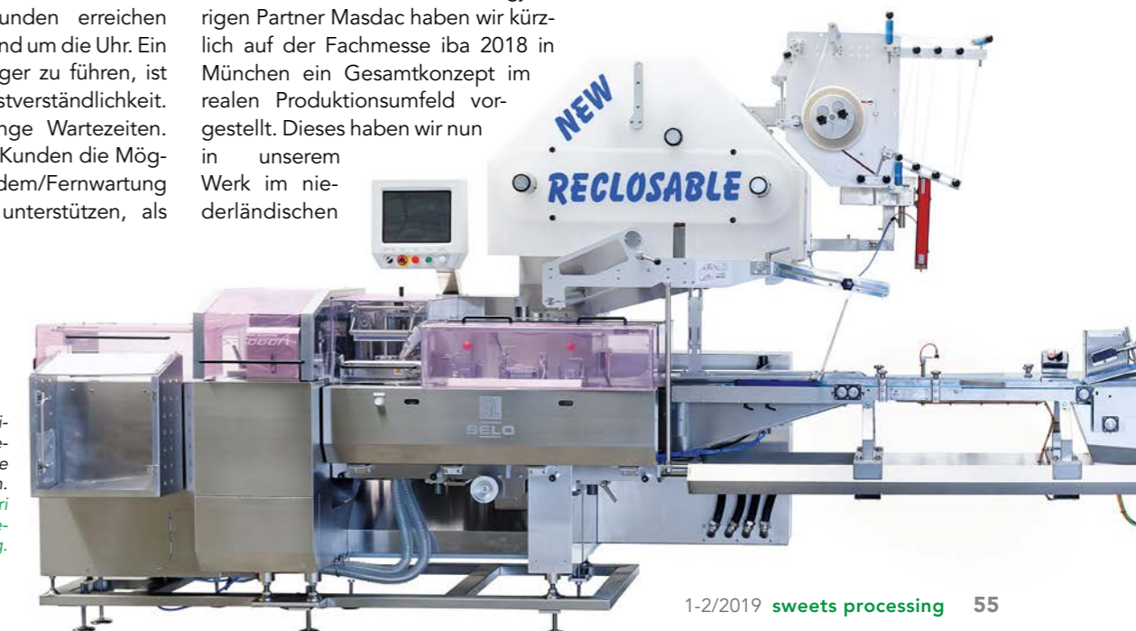
Horizontaler Omori-Flowpacker für wiederverschließbare Verpackungen. Horizontal Omori flow packer for reclosable packaging.
