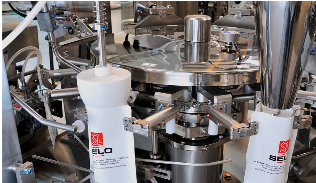
Leepack in Aktion: Abfüllung vorgefertigter Standbodenbeutel. (Bilder: Selo-Omori) Leepack in action: filling of prefabricated doypacks (Images: Selo-Omori)
