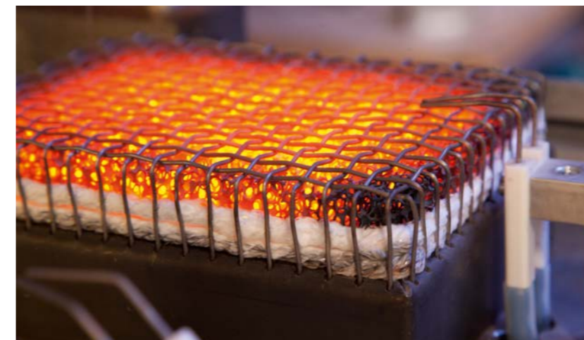
Das Herzstück der Innovation ist ein Porenbrenner, der sich als besonders energieeffizient, schadstoffarm und robust erwiesen hat. The heart of the innovation is a porous burner that has proven to be highly energy efficient, low in emissions and robust.
