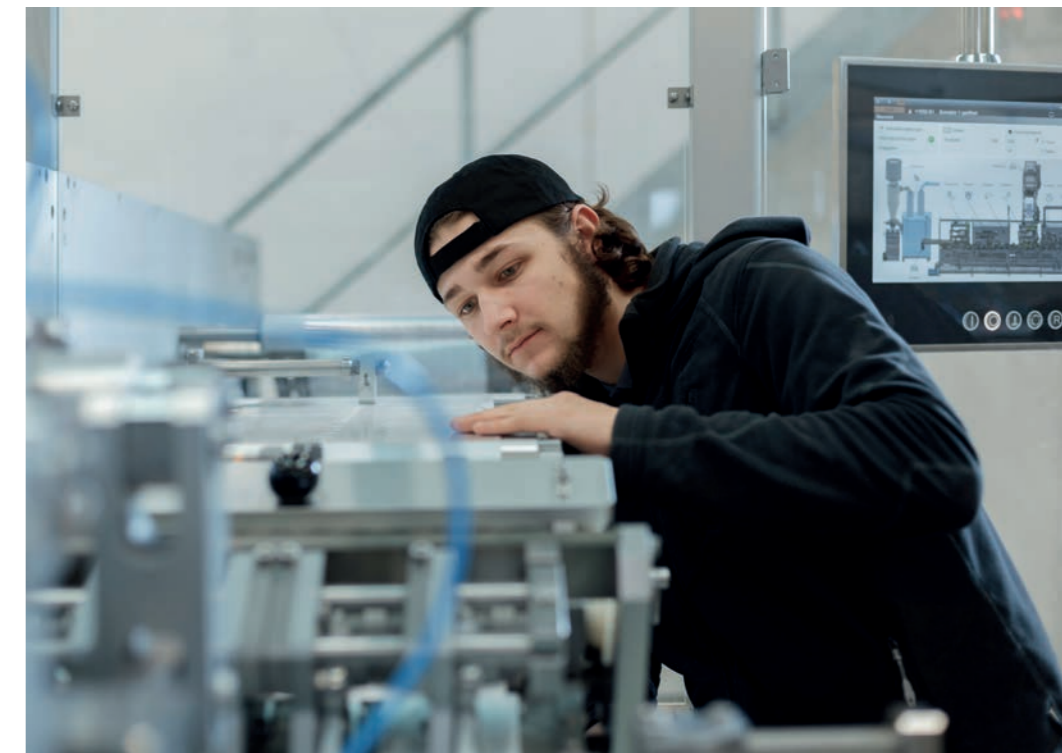
Einstellungen an der hochpräzisen Verpackungsmaschine Stampac TC 400 für Schokoladenhohlkörper in vorgeformter Alufolie. Settings on the high-precision packaging machine Stampac TC 400 for chocolate hollow figures in preformed aluminum foil.
