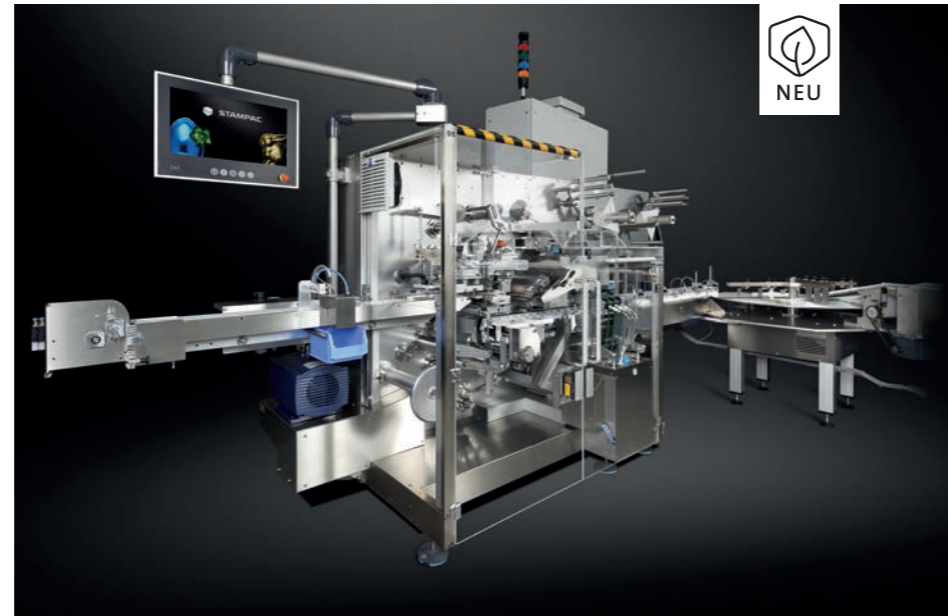
Die Verpackungsmaschinen Leko-LUP und Leko-LUP eco sind vielfältig einsetzbar: Twisten, Wickeln oder Falten, in Papier, Öko-Papier, Kunststoffolie oder Alufolie. (Bilder: Marc Brugger) The Leko-LUP and Leko-LUP eco packaging machines offer a wide range of versatility: twisting, wrapping or folding, in paper, eco paper, plastic film or aluminium foil. (Images: Marc Brugger)
