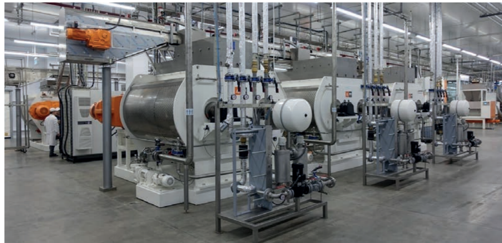
Die energieeffiziente Doppel-Wellen-Conche HBC 3. (Bild: HDM) The energy-efficient Double Shaft Conch type HBC 3. (Image: HDM)
