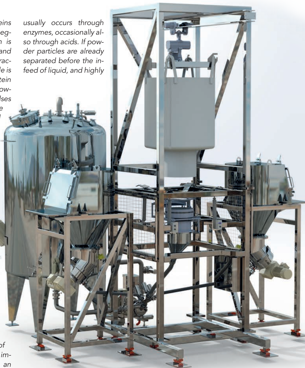
Beispiel einer Prozessanlage mit zwei Sackaufgaben, einer Big-Bag-Station, einer Ystral Conti-TDS Inline-Dispergiermaschine und einem Prozessbehälter mit ystral Leitstrahlmischer. Example of a process system with two bag infeeds, one big bag station, one Ystral Conti-TDS Inline dispersing machine and one process vessel with Ystral Jetstream Mixer.
