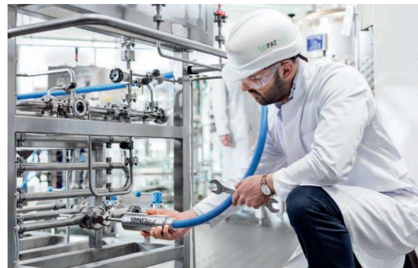
Das fotooptische Partikelmesssystem ChocoScope wird direkt im Prozess installiert. (Bilder: Sopat) ChocoScope photo-optical particle measurement system is installed directly in the process. (Images: Sopat)
