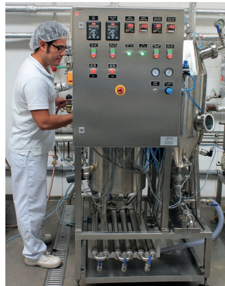
Ein Mitarbeiter von D&F Drouven reinigt im modern ausgestatteten Labor die Koch- und Löseeinheit. In the modernly equipped laboratory, an employee of D&F Drouven cleans the cooking and dissolving unit.
