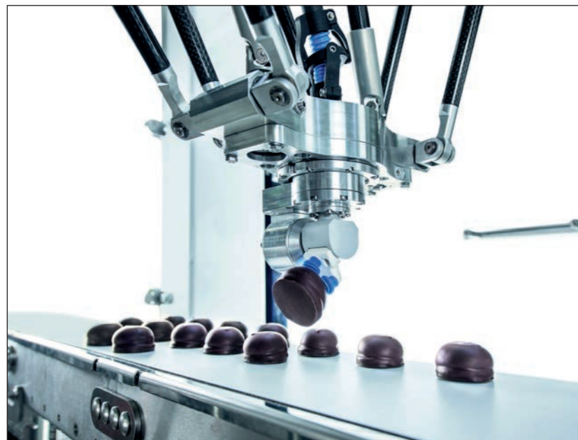
Die Roboter-Variante T5 besitzt eine fünfte Achse, mit der sich Produkte schwenken und kippen lassen. (Bild: Schubert) The T5 robot variant features a fifth axis which can be used to swivel and tilt products. (Image: Schubert)
