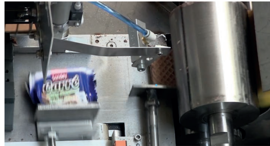
Die Walzen entfernen die Verpackung, während die reine Waffel (Bildmitte) mit einem Schieber ausgebracht wird. Das Verpackungsmaterial wird durch ein Vakuum abgesaugt. The rollers remove the packaging, while the pure wafer (centre of picture) is discharged with a pusher. The packaging material is sucked off by a vacuum and collected for recycling.
