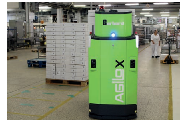
Das Transportsystem Agilox IGV überwindet selbstständig Schranken, Tore und Stockwerke. The transport system Agilox IGV is able to handle barriers, gates and various floors.
