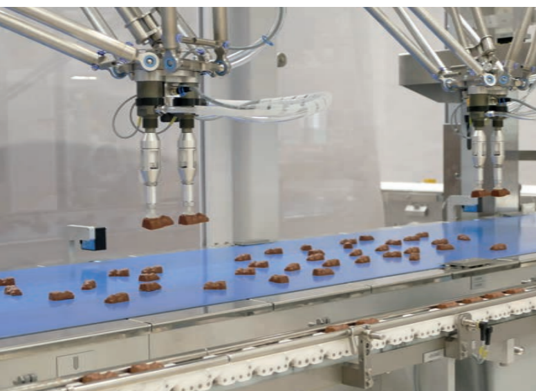
Die Roboterzuführung Vision Picker macht das Verpacken effizienter. (Bild: Theegarten-Pactec) The robot feeding system Vision Picker makes packaging more efficient. (Image: Theegarten-Pactec)
