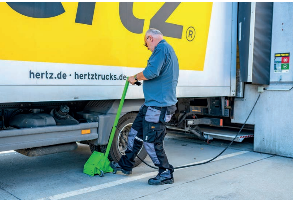
Zunächst muss der Trucker den Unterlegkeil richtig platzieren. Erst dann kann der Lagerist das Tor öffnen. (Bilder: My Intralogistik) First, the driver has to place Keilstop correctly. Only then, the gate can be opened by the warehouse worker. (Images: My Intralogistik)
