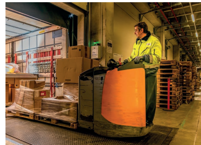
Das grüne Licht am Bedienterminal erlaubt sicheres Be- und Entladen. Wird der Keilstop unerlaubt entfernt, warnen Lichtsignal und Sirene das Hallenpersonal. The green light on the operator terminal guarantees safe loading and unloading. If the wheel chock is removed without permission, the light signal and alarm warn the hall staff.
