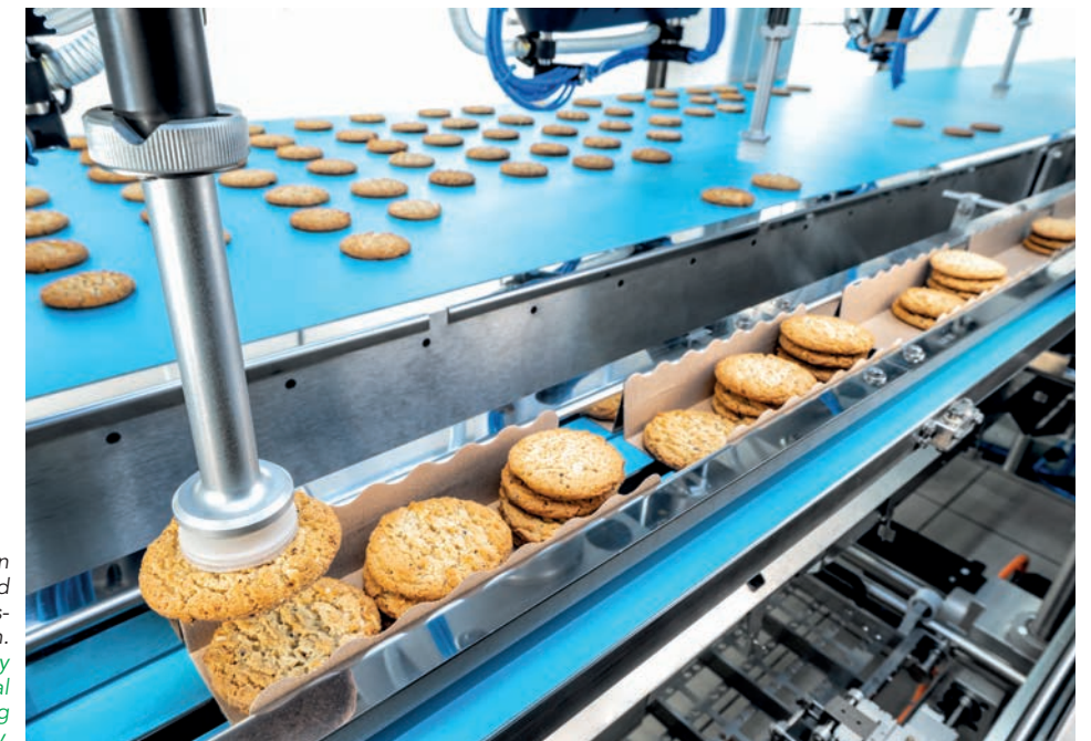
In den Schubert-Anlagen kann zwischen herkömmlichen und nachhaltigen Verpackungsmaterialien gewechselt werden. In the Schubert lines, easy switching between conventional and sustainable packaging materials is a reality.
