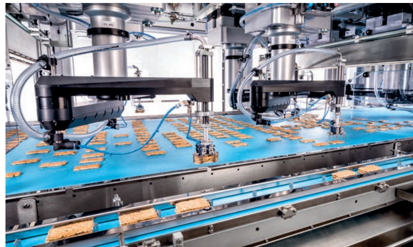
Pick-and-Place-Roboter greifen die Backwaren schonend auf und setzen sie genau ab. Pick & place robots gently pick up the baked goods and place them with precision.
