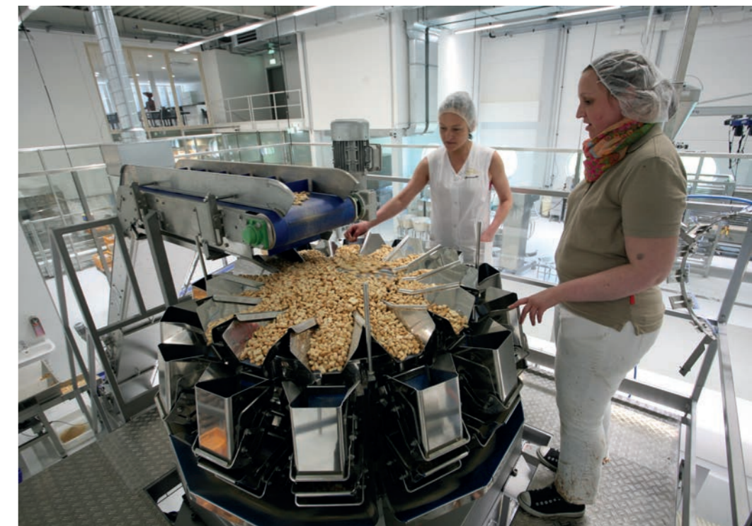
Die neue Mehrkopfwaage CCW-RV-GS ermöglicht eine leistungsstarke und zugleich schonende Verpackung von Wibeles und Co. (Bilder: Ishida) The new CCW-RV-GS multihead weigher makes high-performance, gentle packaging possible for Wibeles biscuits and other breakable confectionery. (Images: Ishida)
