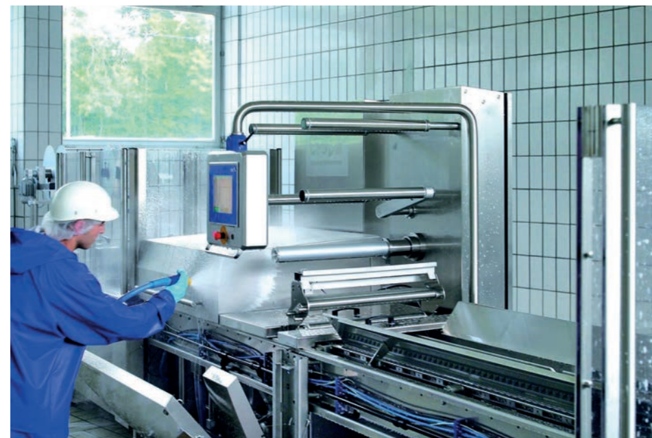
Ein Niederberger-Mitarbeiter im Reinigungseinsatz: Wasser mit einem Druck von 20 bis 25 bar entfernt im ersten Schritt grobe Rückstände von Anlagen und Böden. A Niederberger employee in the cleaning operation: in the first step, water with a pressure of 20 to 25 bar removes coarse residues from systems and floors.
