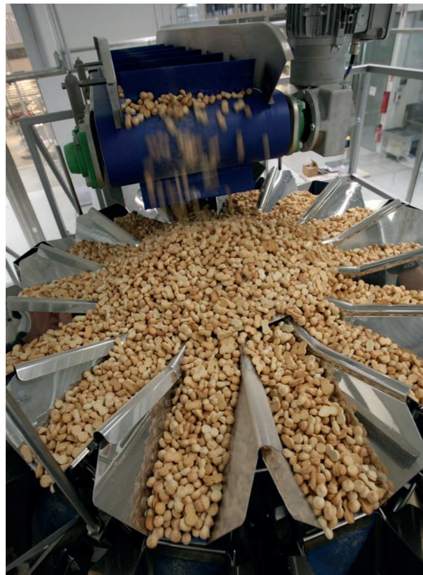
Die Wibeles werden durch vibrierende Rinnen zu den Schalen der Waage befördert. The Wibeles biscuits are conveyed through vibrating gutters to the weigher bowls.
