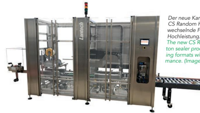
Der neue Kartonverschießer CS Random HS verarbeitet wechselnde Formate mit Hochleistung. (Bild: Lantech)
