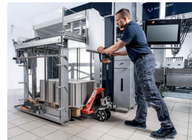
Zu den zentralen Zukunftstechnologien gehört der ressourcenschonende TLM Comfort Feeder in Verbindung mit dem A3-Schachtelaufrichter zur Zuführung von Kartonzuschnitten. Key future technologies include the resource-saving TLM Comfort Feeder in conjunction with the A3 carton erector for feeding cardboard blanks.
