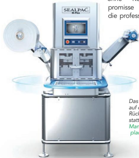
Das manuelle Be- und Entladen der Anlage erfolgt auf der Vorderseite der Anlage, während auf der Rückseite gleichzeitig der Versiegelungsprozess stattfindet. (Bild: Sealpac)
