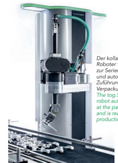
Der kollaborative Roboter tog.519 wurde zur Serienreife gebracht und automatisiert die Zuführung an der Verpackungsmaschine. The tog.519 collaborative robot automates feeding at the packaging machine and is ready for series production.
