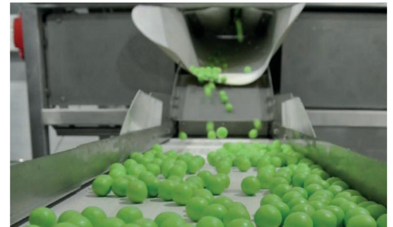
Balls CT output: weiche, mit Flüssigkeit gefüllte Bonbonkugeln, die nach der Formgebung in einen Kühltisch fallen, in einem Proform Ball Former.
