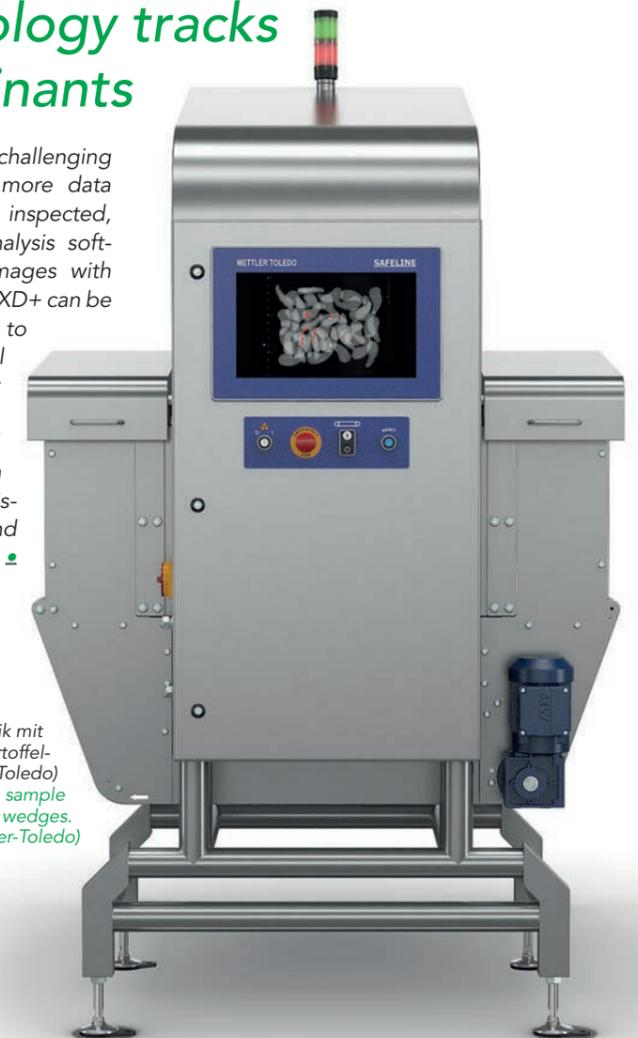
DXD-Detektortechnik mit Beispielbild von Kartoffel-spalten. (Bild: Mettler-Toledo)
