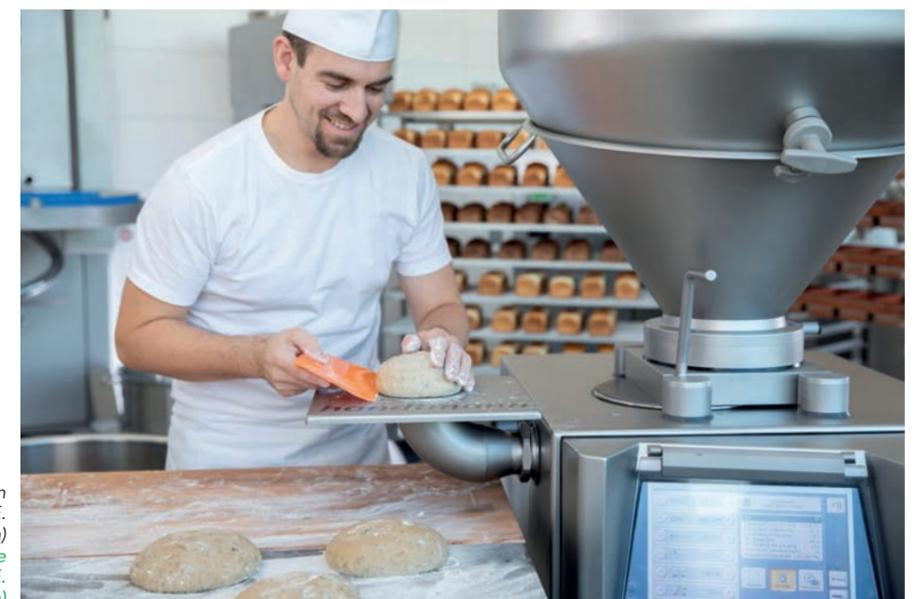
Teigteilen mit der manuellen Portioniereinheit MPE. (Bild: Handtmann)
