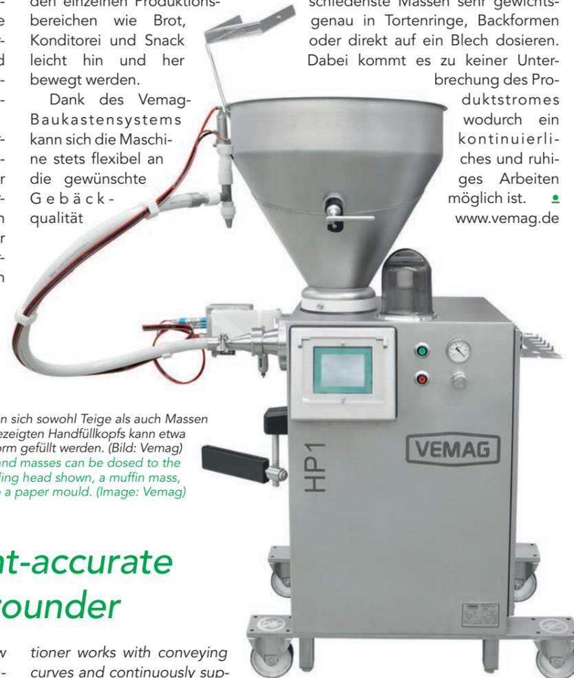
Mit dem Portionierer HP1 lassen sich sowohl Teige als auch Massen grammgenau dosieren. Mithilfe des gezeigten Handfüllkopfs kann etwa eine Muffin-Masse exakt in eine Papierform gefüllt werden. (Bild: Vemag)
