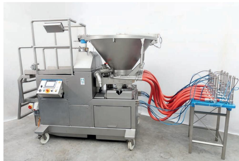
Der mobile „Füller Typ Disk“ dosiert flüssige bis pastöse Produkte an bis zu zwölf Füllstellen mit nur einer Steuerscheibe.
