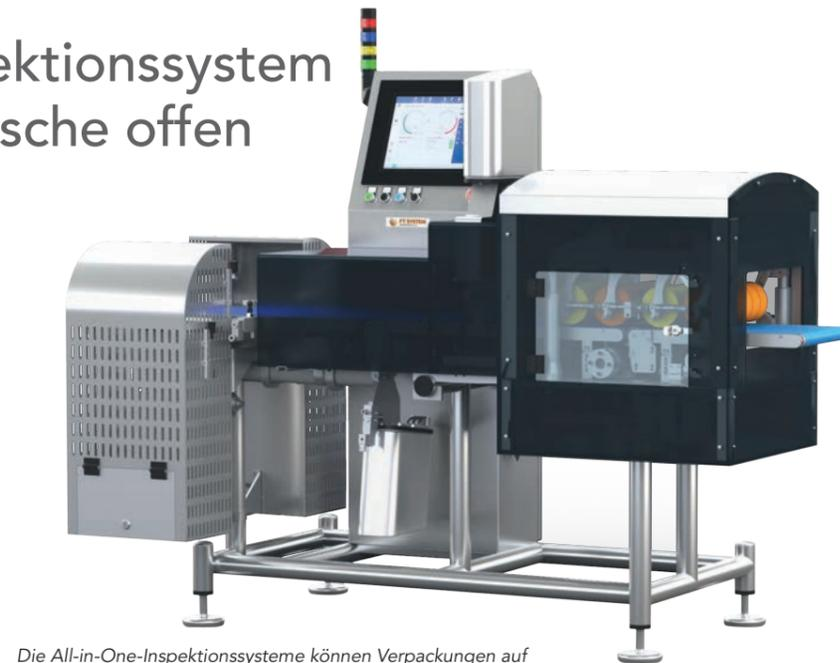
Die All-in-One-Inspektionssysteme können Verpackungen auf Mikrolecks prüfen, Fremdkörper aufspüren, das Produktgewicht kontrollieren sowie die Versiegelung, Etiketten und Codes prüfen. (Bild: AVG)
