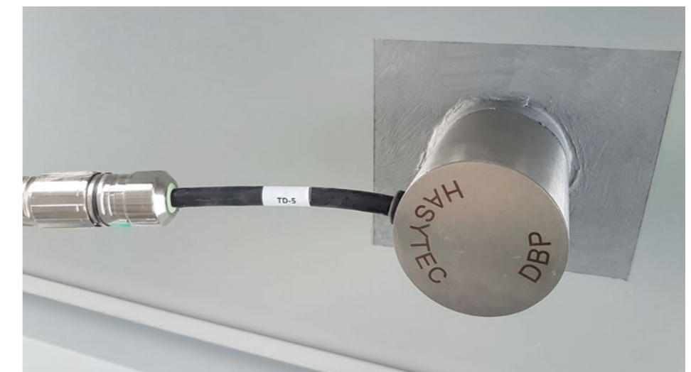
Die Schallgeber werden auf die zu schützende Anwendung geklebt. Die ausgesandten Ultraschallsignale durchdringen die Oberfläche, diffundieren in das Medium (etwa Wasser), zerstören die Zellmembran der Einzeller und verhindern die Ansiedlung von Biofilmen. The sound transducers are glued to the application to be protected. The emitted ultrasonic signals penetrate the surface, diffuse into the medium (such as water), destroy the cell membrane of the protozoa and prevent the settlement of biofilms.
