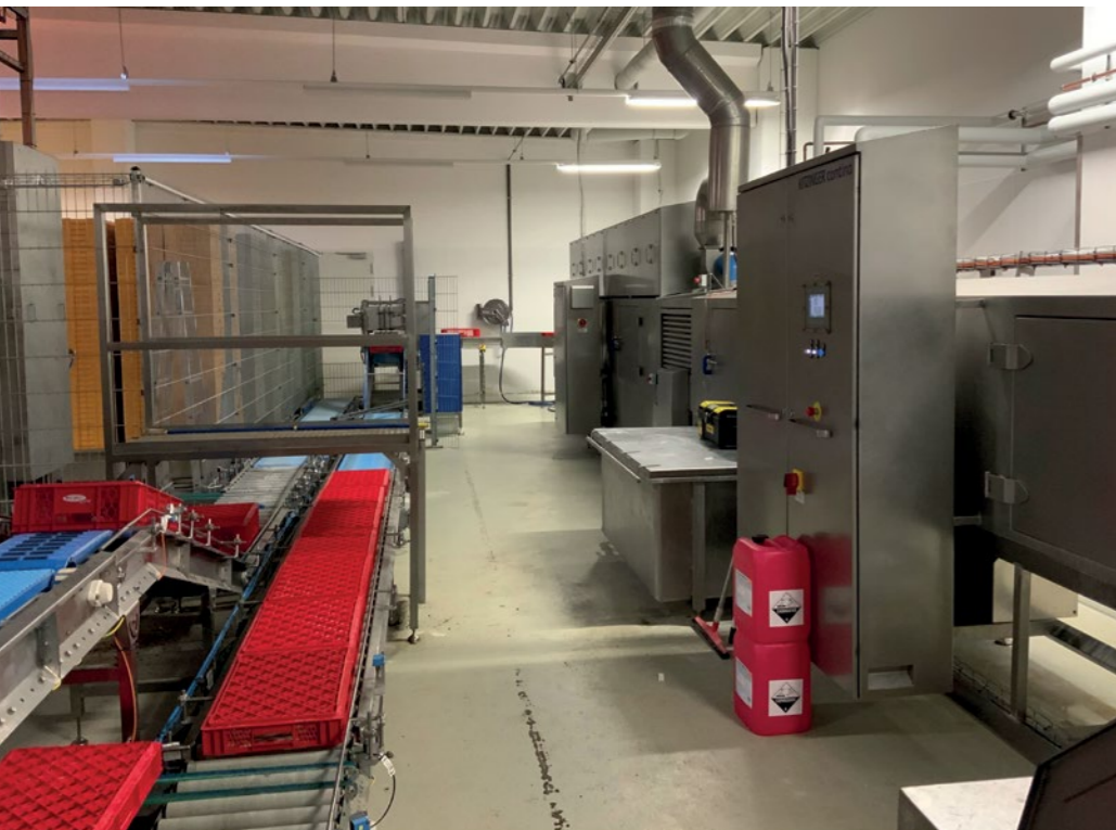
Die Korbwaschmaschine der Firma Steiskal reinigt mehrere hundert Körbe am Tag. The basket washing machine from Steiskal cleans several hundred baskets a day.
