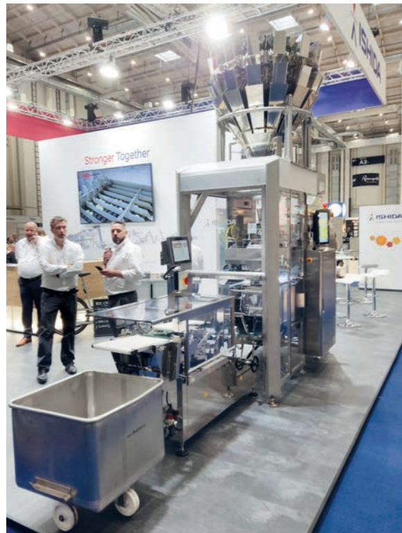
Die im Snack-Verpackungssystem iTPS von Ishida integrierte Schlauchbeutelmaschine Inspira ist die schnellste ihrer Art. The Inspira form, fill and seal machine integrated into Ishida's iTPS snack packaging system is the fastest of its kind.
