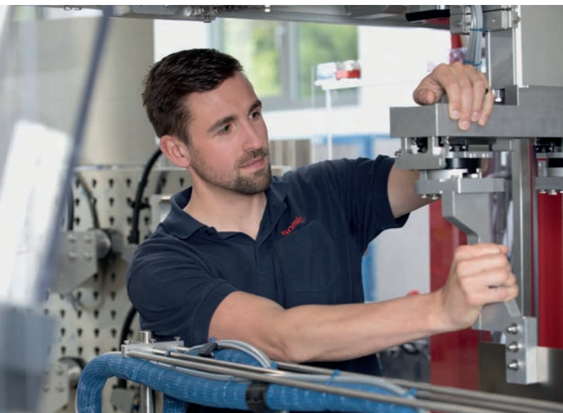
Schnelle Formatumstellung mit dem Somic-Quick-Change-System. Quick format changeover with the Somic quick change system.
