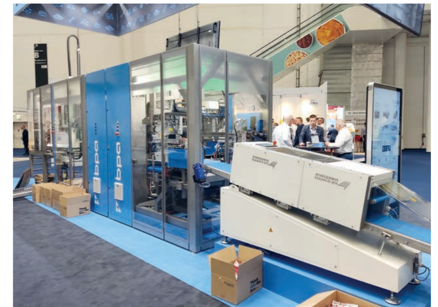
Der neue Snackmaster 200i von BPA ist mit einem voll integrierten RSC-Kartonaufrichter und -Bandverschießer ausgestattet. BPA's new Snackmaster 200i is equipped with a fully integrated RSC case erector and tape closer.
