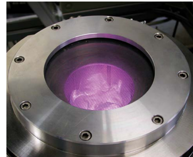
Anlage zur Plasmaentkeimung von Verpackungen und Lebensmitteln. Plant for plasma sterilisation of food and packaging materials.
