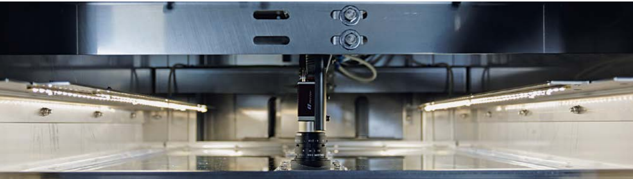
Aufnahmetechnik und LED-Beleuchtung sind durch eine Filterscheibe nach unten gegen die Leerformen abgeschirmt. Cameras and LED lighting are shielded against the empty moulds by a protective pane.
