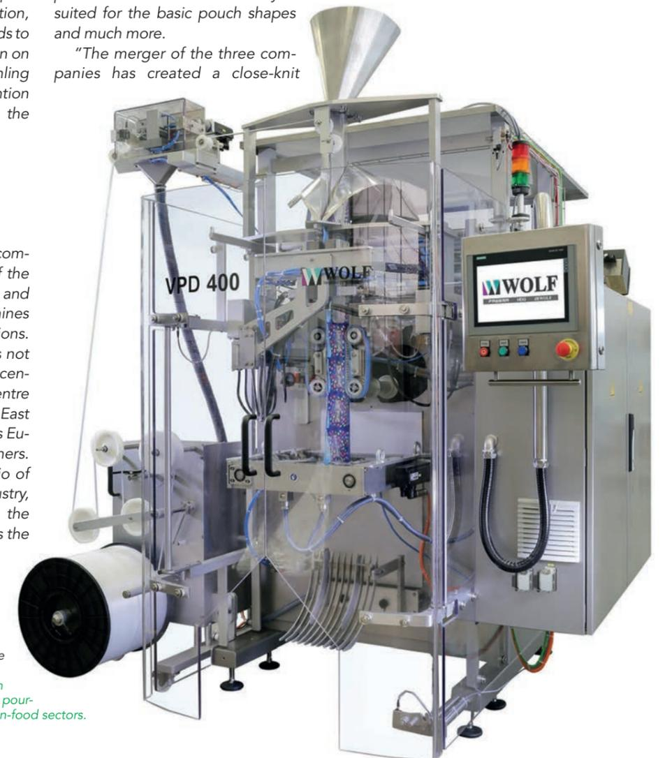
Die Schlauchbeutelmaschine VPC 400 von Wolf ist konzipiert zum Verpacken frei fließender, schüttfähiger oder pastöser Produkte aus dem Food- und Non-Food-Bereich.
