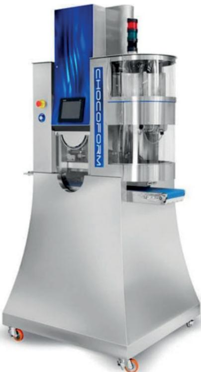
Chocoform ist ein neues System zum Ausformen vorab angefertigter Massezylinder aus Schokolade, Nougat, Mandelmasse etc. mit höheren Leistungen. Chocoform is a new system for moulding pre-made mass cylinders of chocolate, nougat, almond paste etc. with higher outputs.
