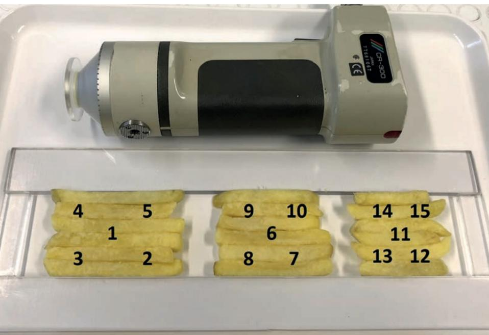
Exemplarische Farbmessung von Pommes frites an langen (l.), mittellangen (m.) und kurzen (r.) Pommes-Stäbchen mit eingezeichneten Messstellen (1 bis 15); verwendetes Farbmessgerät: Minolta CR 300 Chroma Meter. (Bild: Nikolay)
