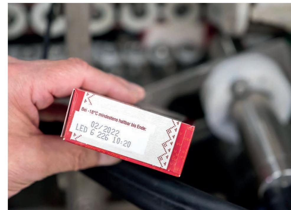
Ein Continuous-Inkjetdrucker des Typs Linx 8920 kennzeichnet die Produktverpackungen. A Linx 8920 continuous inkjet printer marks the product packaging.
