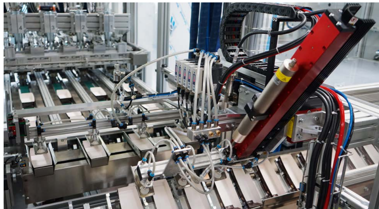
Das EPS-Handlingsystem maxi XZ 350E/300E in der Station Vierfach-Karton-Übersetzer besteht aus einer EPS-Portalachse PDL40-0350-D19 (Horizontalbewegung) sowie einem EPS-Elektroschlitten ES30-300 mit Doppelführungswagen (Vertikalbewegung). (Bilder: Afag) The maxi XZ 350E/300E handling system from EPS in the four-fold cardboard assembler station consists of an EPS PDL40-0350-D19 portal axis (horizontal movement) and an EPS ES30-300 electric slide with double guide carriage (vertical movement). (Images: Afag)
