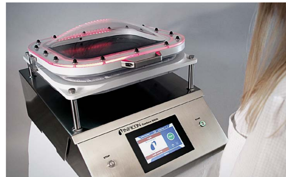
Bei der Differenzdruckmethode weist ein rotes Signal den Bediener auf eine zu hohe Leckrate hin, wie hier bei dem Leckprüfgerät Contura S400 von Inficon. (Bilder: Inficon) In the differential pressure method, a red signal indicates that the operator is experiencing too high a leak rate, as is the case here with the Contura S400 leak detector from Inficon. (Images: Inficon)
